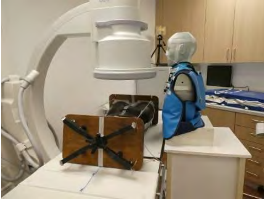
Abb. 1: Aufbau der Phantommessung am C-Bogen
