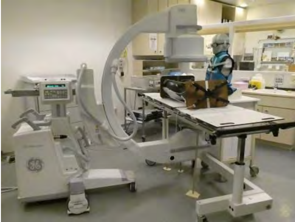
Abb. 1: Aufbau der Phantommessung am C-Bogen
