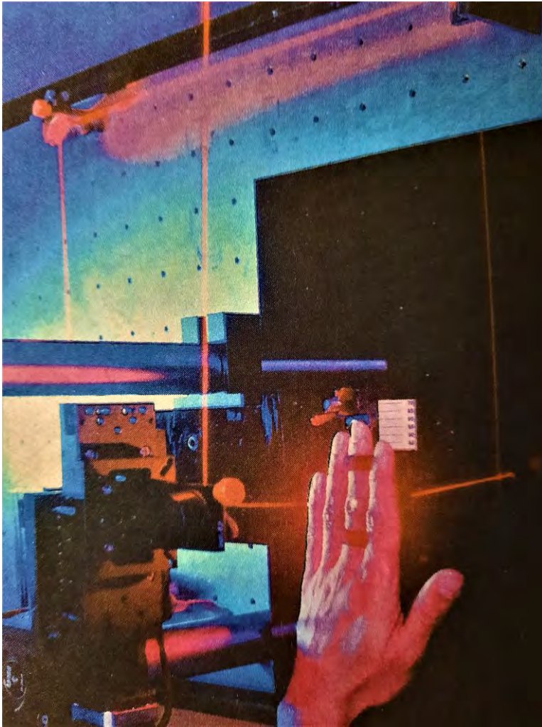
Abb. 1: Einfache experimentelle Anordnung eines Laser-Scanners zur Durchleuchtung von Fingergelenken im NIR-Strahlungsbereich (700-1300 nm).
