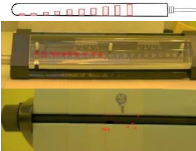
Abb.1: Oben: Schematische Darstellung des Bestrahlungsplans mit 10 Haltepositionen, konstanten Schrittweiten von 1 cm und steigenden Haltezeiten. Zusammenstellung der Aufnahmen mit den 10 Haltepositionen im Source Step Viewer (Mitte) und im CBCT Electron Density Phantom (Unten).
